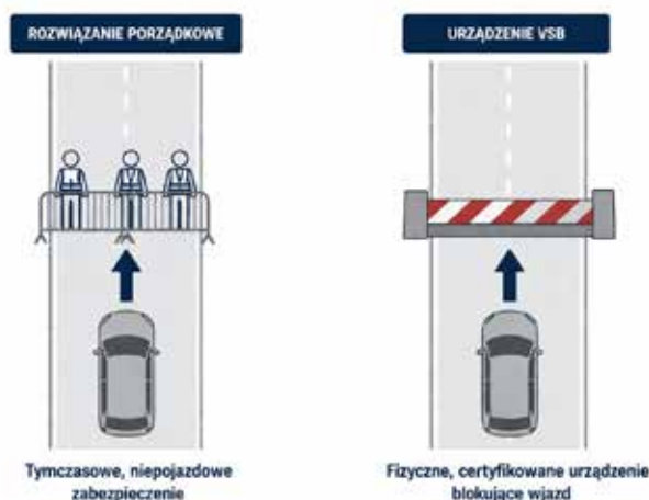
Rysunek 3. Schematy przedstawiające zastosowanie rozwiązania porządkowego oraz zastosowanie bariery pojazdowej VSB.
