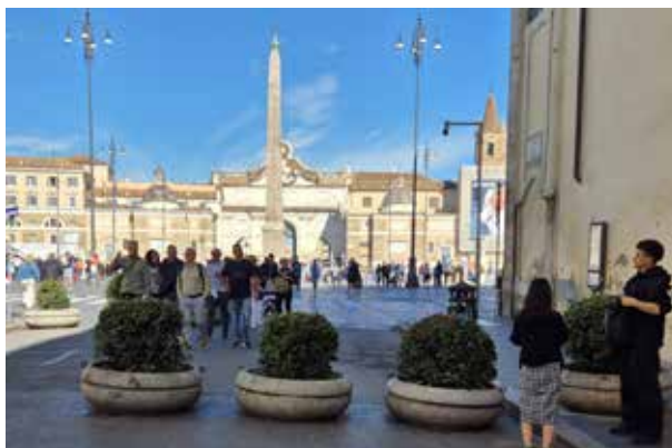
Zdjęcie 6. Donice – elementy małej architektury o funkcji porządkowej lub potencjalnie ochronnej. Ich kwalifikacja jako barier pojazdowych VSB zależy od certyfikacji i scenariusza zastosowania (Rzym).
