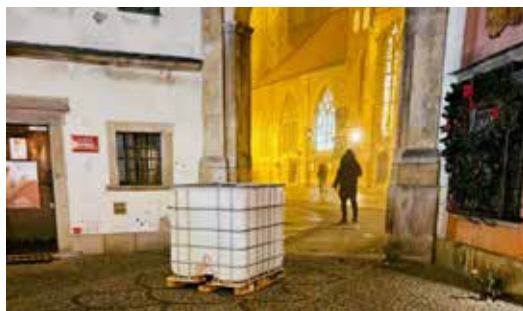
Zdjęcie 5. Pojemnik typu IBC – element porządkowy niebędący barierą pojazdową VSB (Polska).
