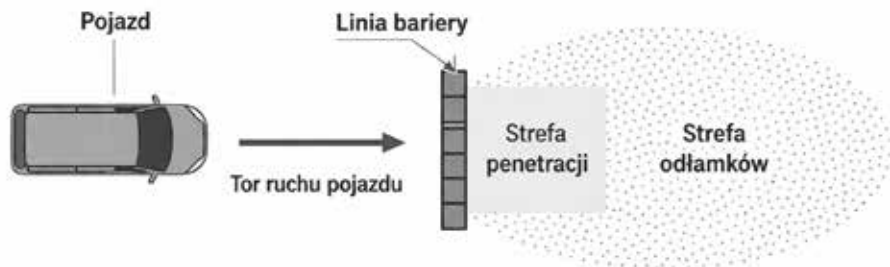
Rysunek 2. Zderzenie pojazdu z barierą pojazdową z zaznaczeniem toru ruchu, linii bariery, strefy penetracji oraz strefy odłamków.
