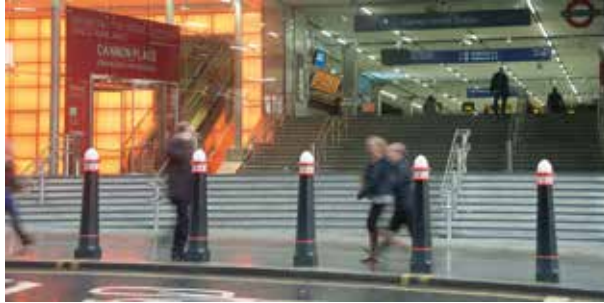
Zdjęcie 14. Bollardy typu „City of London”.
