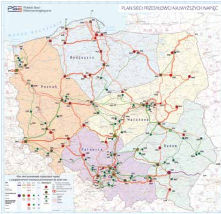
Rys. 1. Schemat sieci elektroenergetycznej w Polsce.
