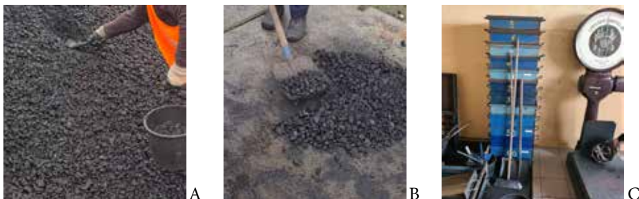
Zdjęcie 2. Opróbowywanie węgla kamiennego – zdjęcia poglądowe: pobieranie próbek pierwotnych (A), kwartowanie (B), zestaw sit do analizy sitowej (C).
