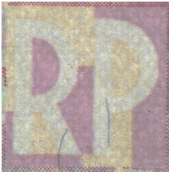
Rys. 16. Zabezpieczenie recto – verso obecne w polskim paszporcie: elementy na przednim i tylnym fragmencie podłoża (A); obraz kompletny, widoczny w świetle przechodzącym (B).
