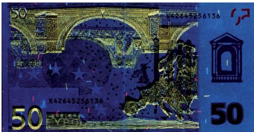
Fot. 27. Falszyfikat banknotu euro w promieniowaniu UV.
