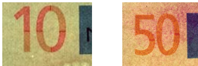
Fot. 18. Porównanie recto-verso na banknocie euro (A) z jego imitacją (B).
