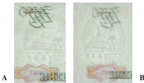
Fot. 1. Porównanie znaku wodnego i kolorowych włókien znajdujących się na oryginalnym banknocie rosyjskim (A) i na fałszyfikacie (B).
