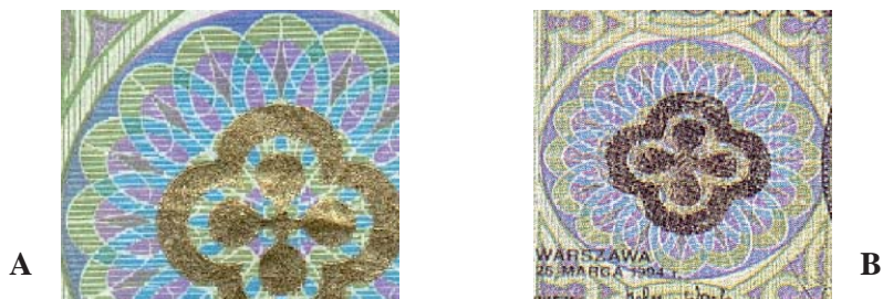
Fot. 21. Porównanie folii zabezpieczającej znajdującej się na oryginalnym polskim banknocie (A) z jej imitacją (B).
