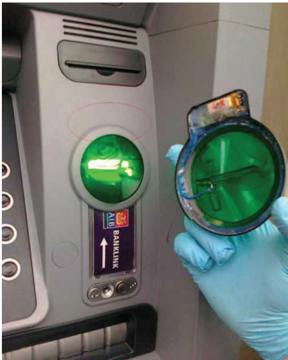
Zdjęcie 1. Przykład modyfikacji bankomatu umożliwiający skimming.
